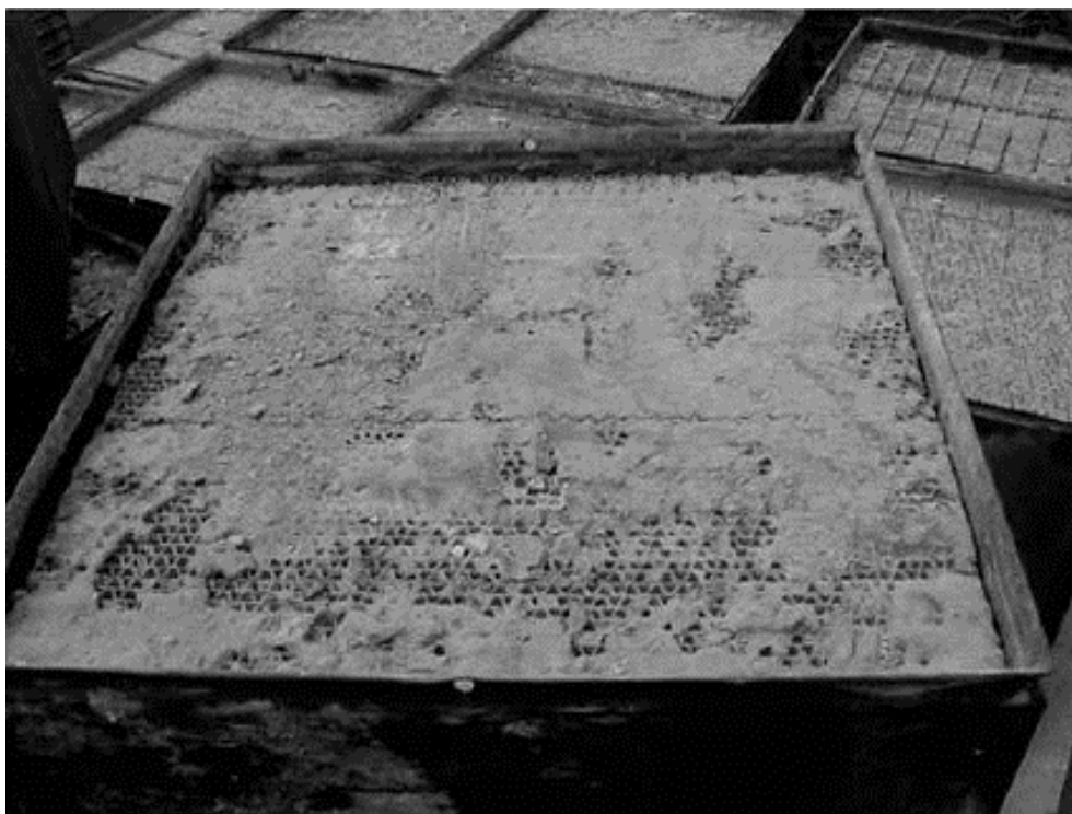
Figura 4. Deposição de incrustações em reatores monolíticos de três vías.
